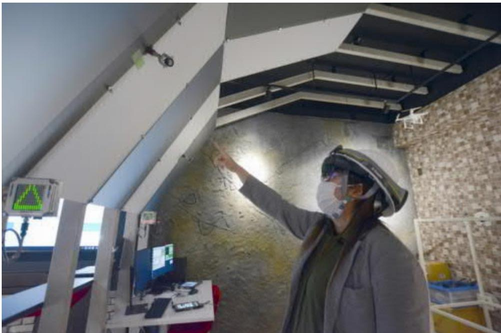
角形の支保工を模した山岳トンネルブースで、ホロレンズを通してA計測の結果を確認中（写真：日経クロステック）
